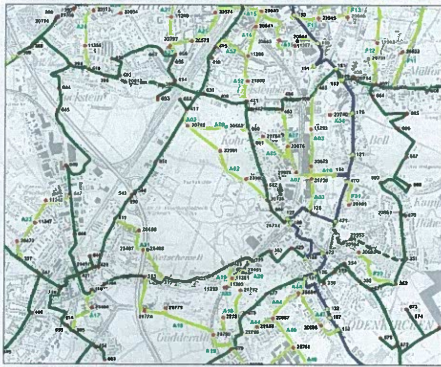
Abb. 8: Schematische Darstellung eines Höhennetzes mit den Nivellementslinien. Hier ein Ausschnitt für die Stadt Mönchengladbach (Weinthal 2012)
