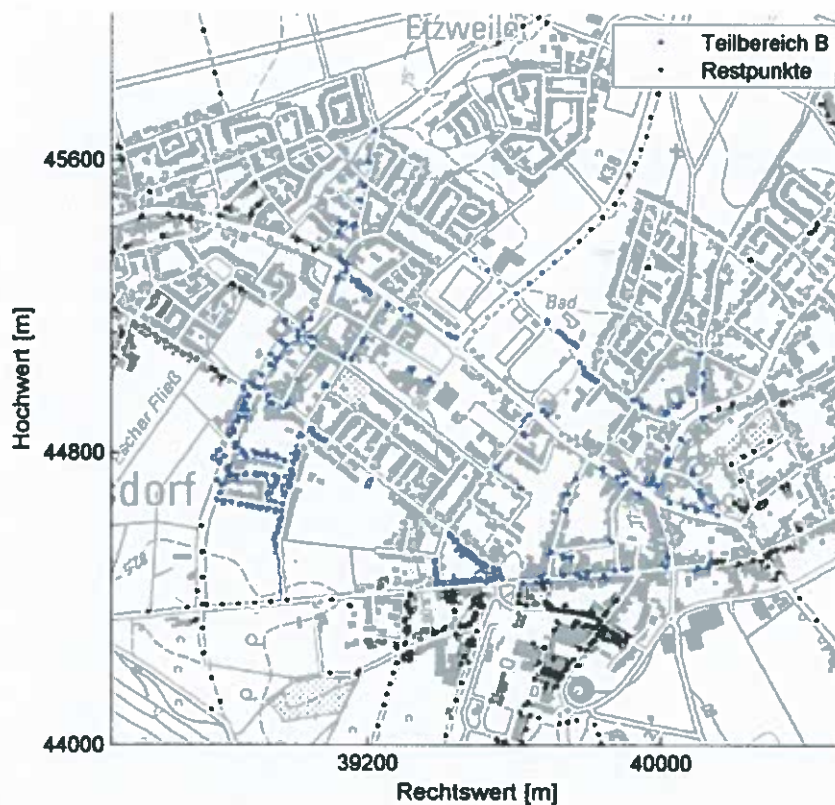
Elsdorf 1: Anordnung der Höhenpunkte in der Ortslage Elsdorf für die Bestimmung von Bodenbewegungen zwischen 1999 - 2011 (vorläufiges Gutachten Elsdorf 2013)
